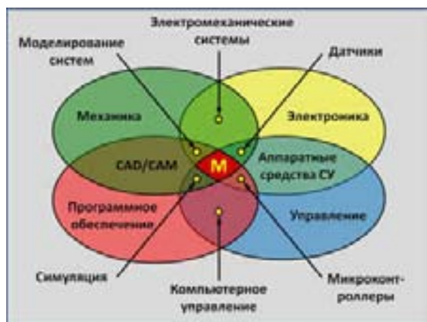
Рис.1. Структурная схема мехатроники
